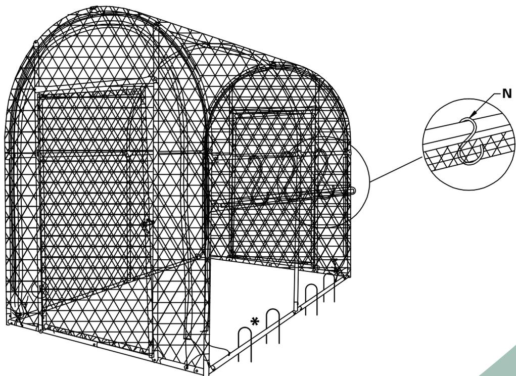
\* Pour maintenir la structure de la serre, il est indispensable de mettre 6 crochets d'ancrage en fer de 12 mm x 350 mm.
